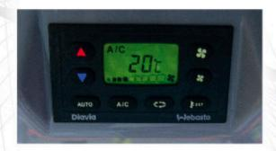
L'impianto di climatizzazione Climax consente di impostare e mantenere costante la temperatura del vano sanitario in maniera completamente automatica, impostando semplicemente la temperatura desiderata (in modalità AUTO, il sistema provvede a regolare la velocità delle ventole e a selezionare le bocchette di erogazione, dall'alto per raffreddare o dal basso per riscaldare l'ambiente).
