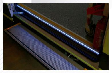
Kit batticalcagni luminosi: per evidenziare le soglie di accesso al vano sanitario e il piano dello stesso, questi profili in alluminio lavorato anti scivolo e dotati di illuminazione a led blu sono installati in corrispondenza del portellone laterale e del portellone posteriore.
